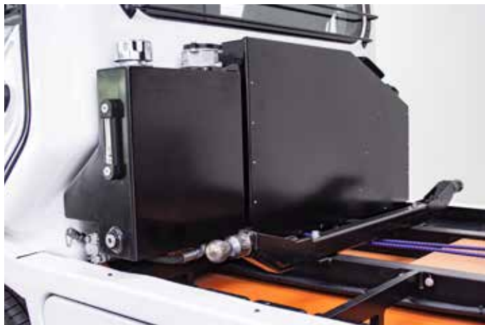
Zentralhydraulikbox kompakt hinter der Kabine integriert, mit elektrischen Hochleistungskomponenten.
